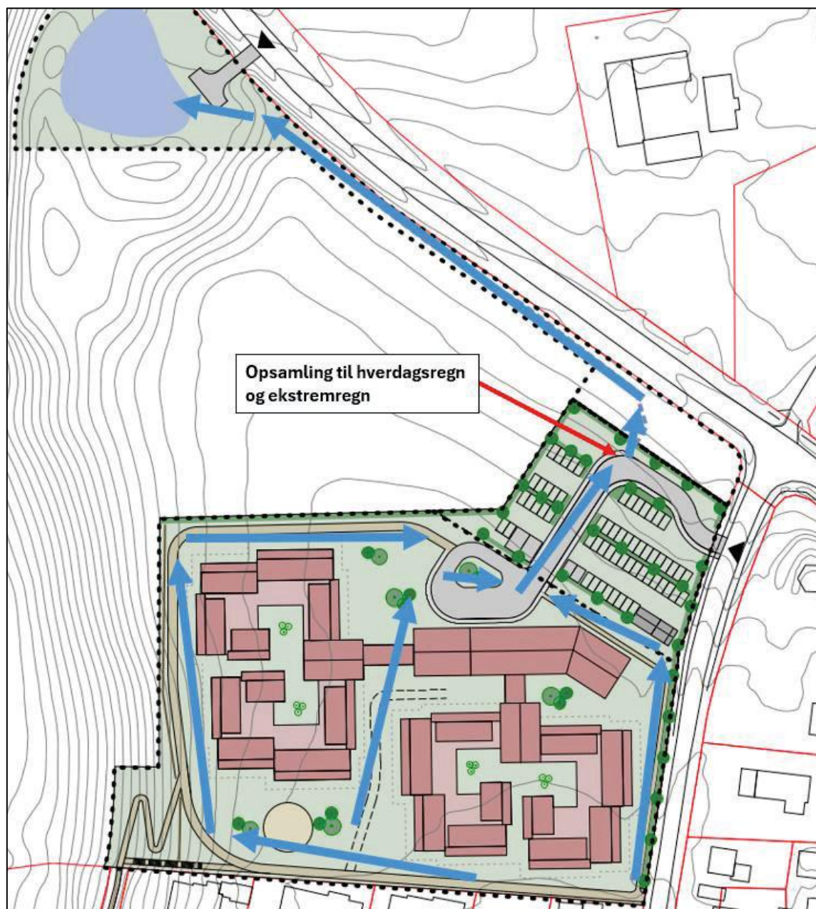
Figur 6 Skitse over interne strømningsveje til sikker håndtering af ekstremregn. Figuren kommer fra vandhåndteringsplanen, udarbejdet af WSP for ansøger og godkendt af Skanderborg Kommune, Vand og Natur.
